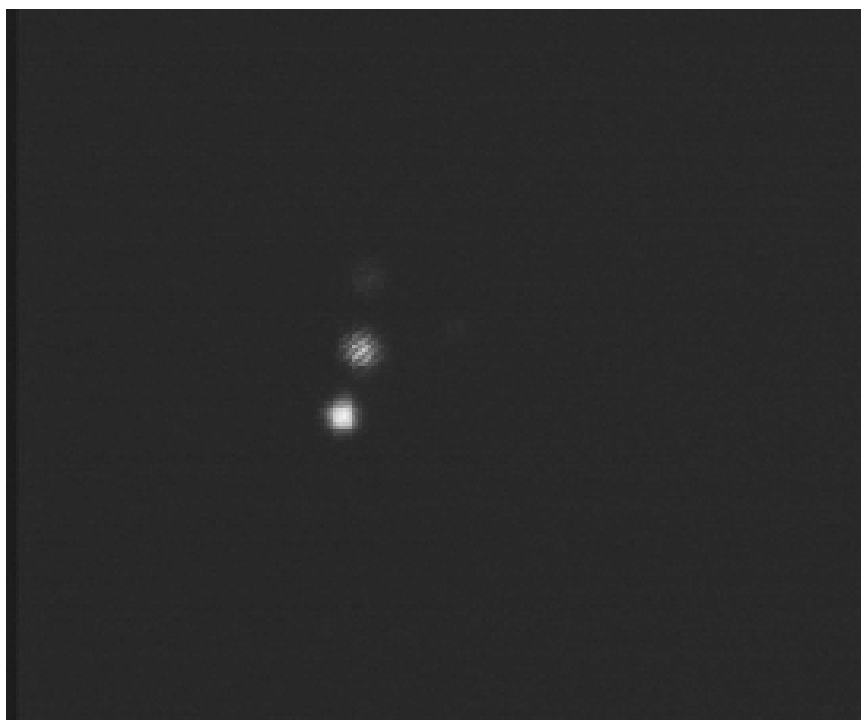
図 14: CCD で撮った生データ：白く見える三つの点がレーザー光であり、左下が非干渉光 1、中央が干渉光で縞模様が見えている、右上が非干渉光 2 を表す。
