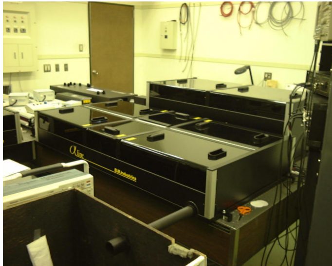
図 3.1: 広島大学先端物質科学研究科ビーム物理学研究室にある、テラワットフェムト秒パルスレーザー。奥にある種光が、その手前のエキスパンダーで波長ごとに時間差を付けてパルスをのばした後、手前のアンプで増強される。その後、左にあるアンプでさらに増強されたパルスは、エキスパンダーの逆操作で再び縮められ、1 テラワット 50 フェムト秒のパルスとなる。
