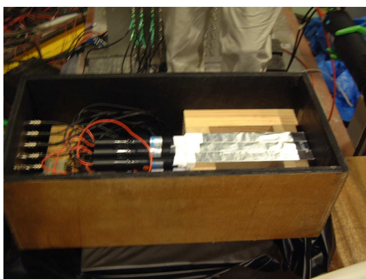
Fig 3-g: PWO 電磁カロリメーター
