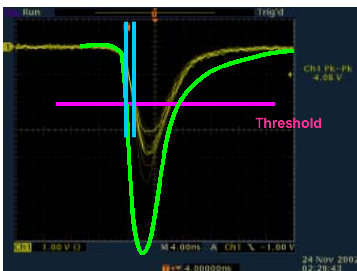
図.2.3.7 入射粒子数による波高の違いと時間のずれ
