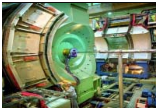
図.2.2.1 北側から見た中央電磁石と中央測定器とビームパイプ
