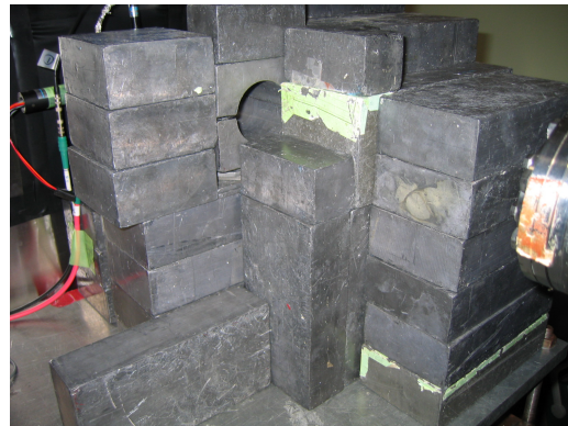
図 3.39: ビーム出口と冷凍庫の間の様子 (斜め前から):コリメータはビームを絞れる一方で散乱された電子を作ってしまうので、コリメータは置いていない。
