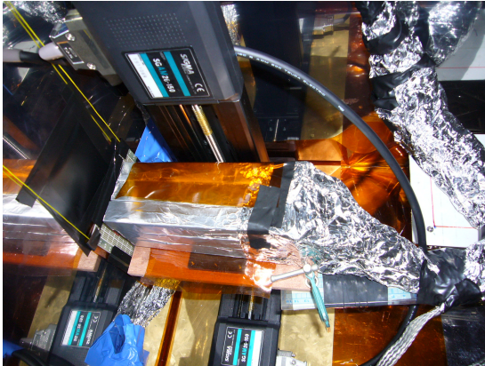
図 3.36: 冷凍庫内のカロリメータの様子(横から):カロリメータは電磁遮蔽のため、アルミ箔で覆っている。前面はLEDでのAPDの動作確認を行なうことができるように開けている。
