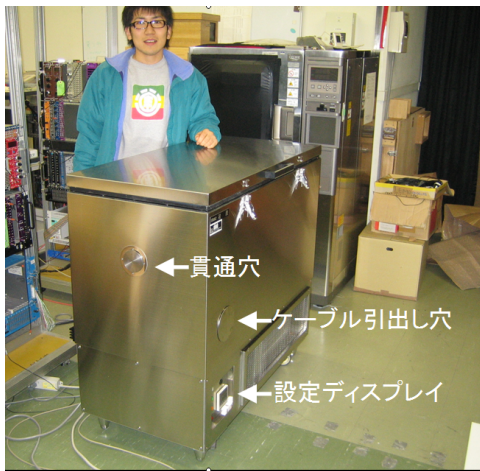
図 3.11: 特注の冷凍庫:図に示すように、冷凍庫にはビーム実験用の貫通穴とケーブル引出し穴がある。また冷凍庫下部のディスプレイにおいて温度設定などを行なう。
