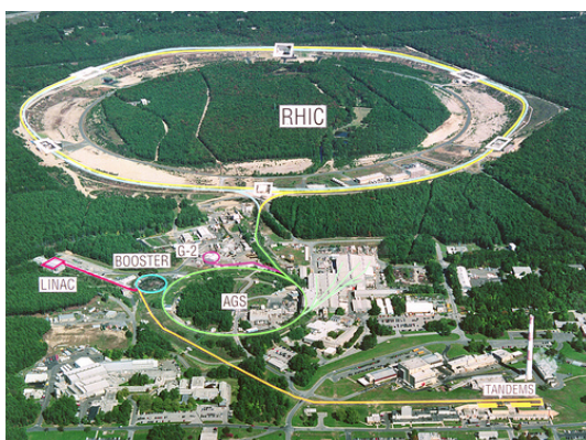
図 4 相対論的重イオン衝突型加速器 [2]: RHIC 加速器の周長は 3.8km であり、金、銅、陽子の高エネルギー衝突実験が行われている。QGP や、それに伴うジェット抑制や楕円の方位角異方性は、この加速器で発見された。
