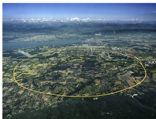
図 5 大型ハドロン衝突型加速器 [3]: LHC 加速器は、周長 27km の世界最大の衝突型加速器である。2010 年 3 月には 7TeV での陽子衝突実験、11 月には 2.76TeV での鉛衝突実験を行い、本格的な TeV 領域の研究が始まった。第 2 章で詳しく述べる。
