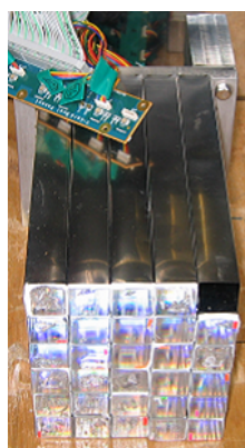
図 12 29本の PWO 結晶が詰まった PWO 結晶群。それぞれに APD が備えられている。以後、この研究において、チャンネルの呼び方を上記の方法で統一する。
