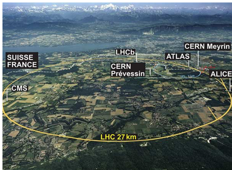
図 7: LHC 加速器の位置と航空写真。周長 27km もの円形ビームパイプがこの地下に埋まっている。写真:CERN
